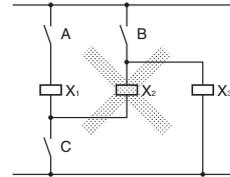
正确电路示例如下所示。在直流电路中，可使用二极管有效预防寄生电流。
